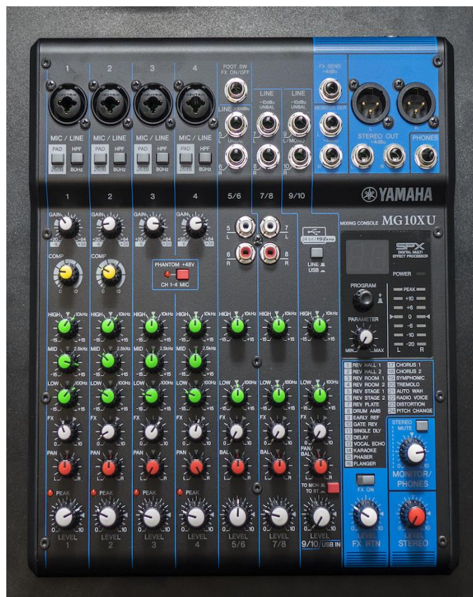
5 pav. Mikšerinis garso pultas skirtas sujungti, susumuoti atskirus garso šaltinius ir juos paduoti į bendrą suminį garso signalą 5 . Yamaha MG-10XU
