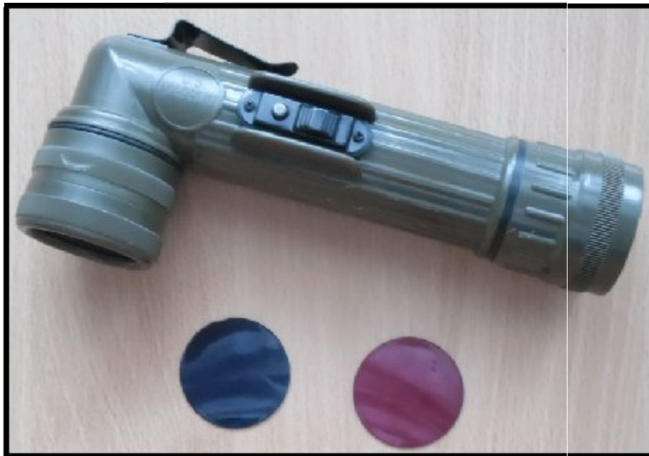
2.5 pav. Prožektorius su mėlynos ir raudonos spalvos filtrais, kuriuo buvo apšviečiama tiriamojo akis
