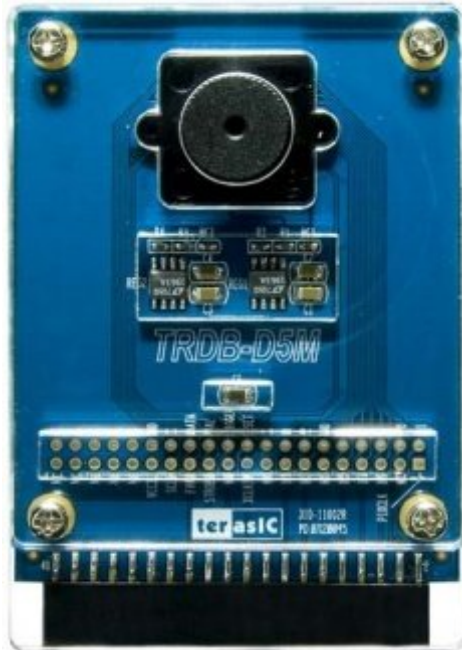
3.4 pav. D5M 5 megapikselių skaitmeninė kamera[19]
