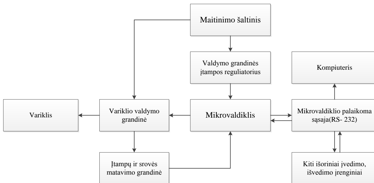
3.1 pav. Projektuojamo valdiklio struktūrinė schema.
