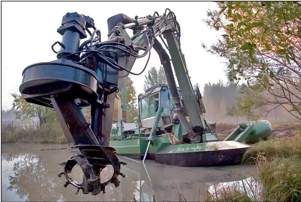
7 pav. „Watermaster Classic III“ su freziniu purentuvu (šaltinis: http://www.watermaster.fi )
