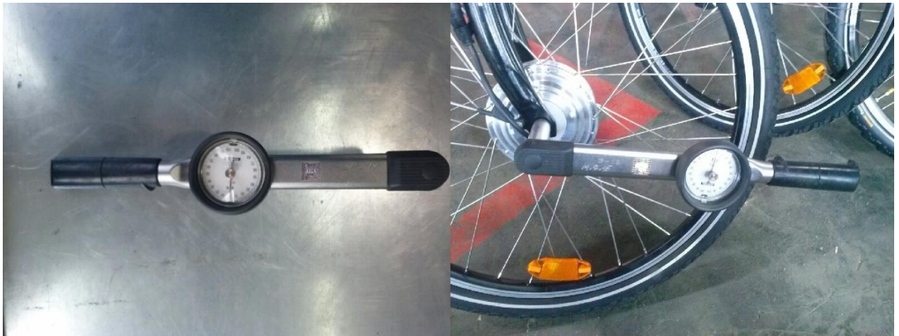
16 pav. Prietaisas skirtas užveržimams matuoti – dinamometras
