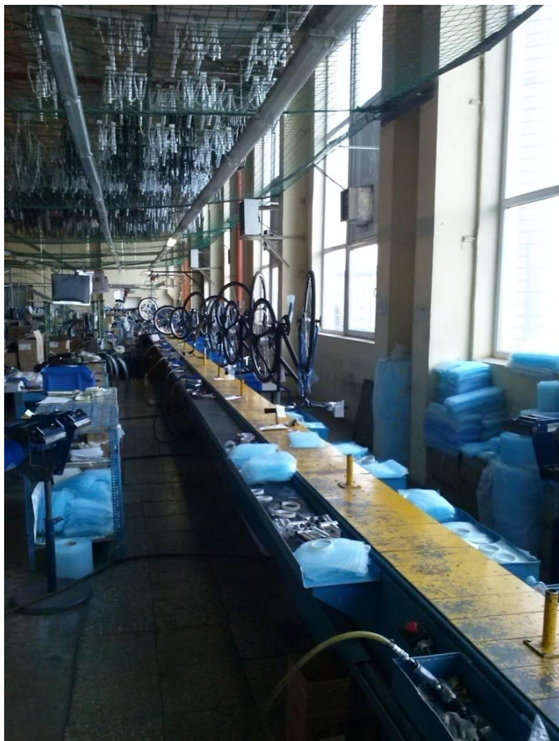
7 pav. Devyniolikos darbo vietų dviračių surinkimo konvejeris
