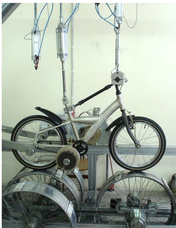
2.4 pav. Struktūrinio vientisumo bandymas, dviračių apkraunant pneumocilindrais ( P_n )
