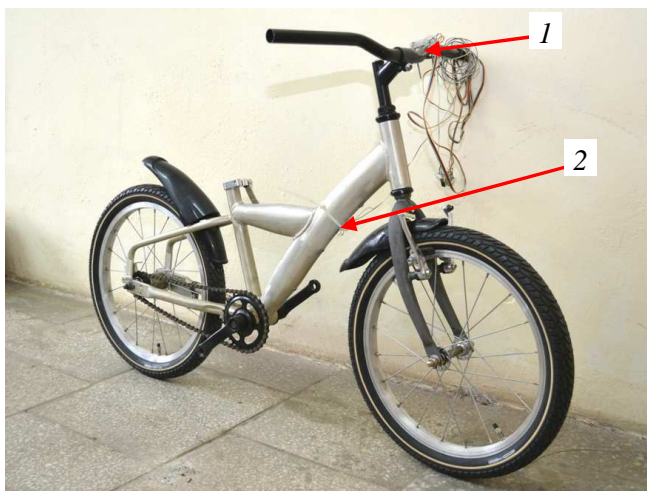
2.2 pav. Tenzorezistorinių jutiklių padėty: 1 – ant vairo; 2 – ant rėmo
