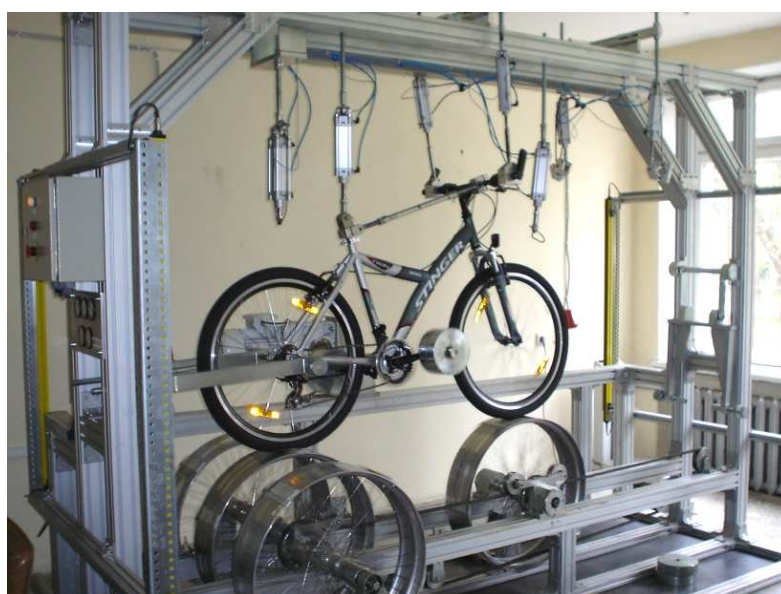
1.3 pav. TBC struktūrinio vientisumo bandymo stendas (aprovimas pneumocilindrais)
