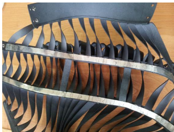
32 pav. Metalinių standinimo detalių kljavimas
