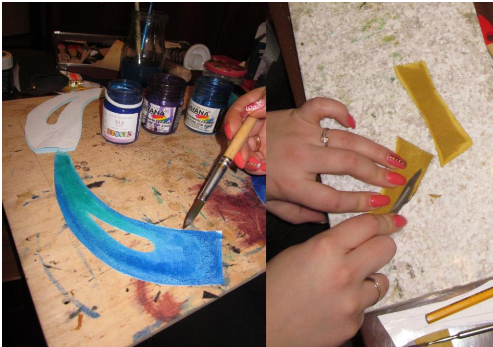
78 – 79 pav. Rankomis dažoma, tonuojama oda. Ploninami detalių krašteliai.
