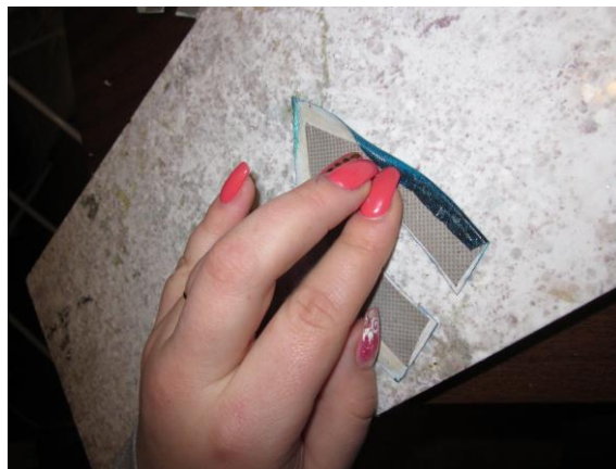
80 pav. Užlankstomi detalių krašteliai
