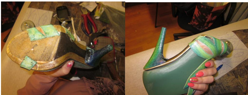
89 -90 pav. Bateliai su primontuotu kulnu, paruošti pado uždėjimui
