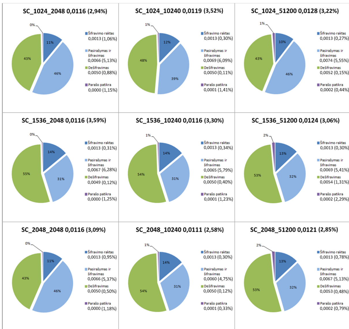
11 paveikslukas. Signcrypton kriptosistemos šifravimo ir dešifravimo bei parašo patikros trukmės, neįskaitant šifravimo ir pasirašymo raktų generavimo trukmę, sekundės
