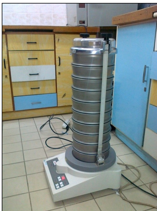
2 pav. „FRITSCH“ firmos rotapas, kurio pagalba buvo sijojami mėginiai (GTC Geologijos ir geografijos instituto laboratorija)
