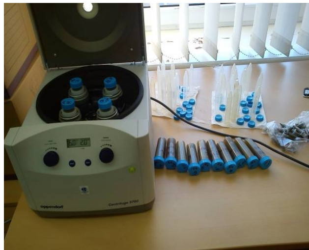
7 pav. Centrifuga „Eppendorf Centrifuge 5702“
