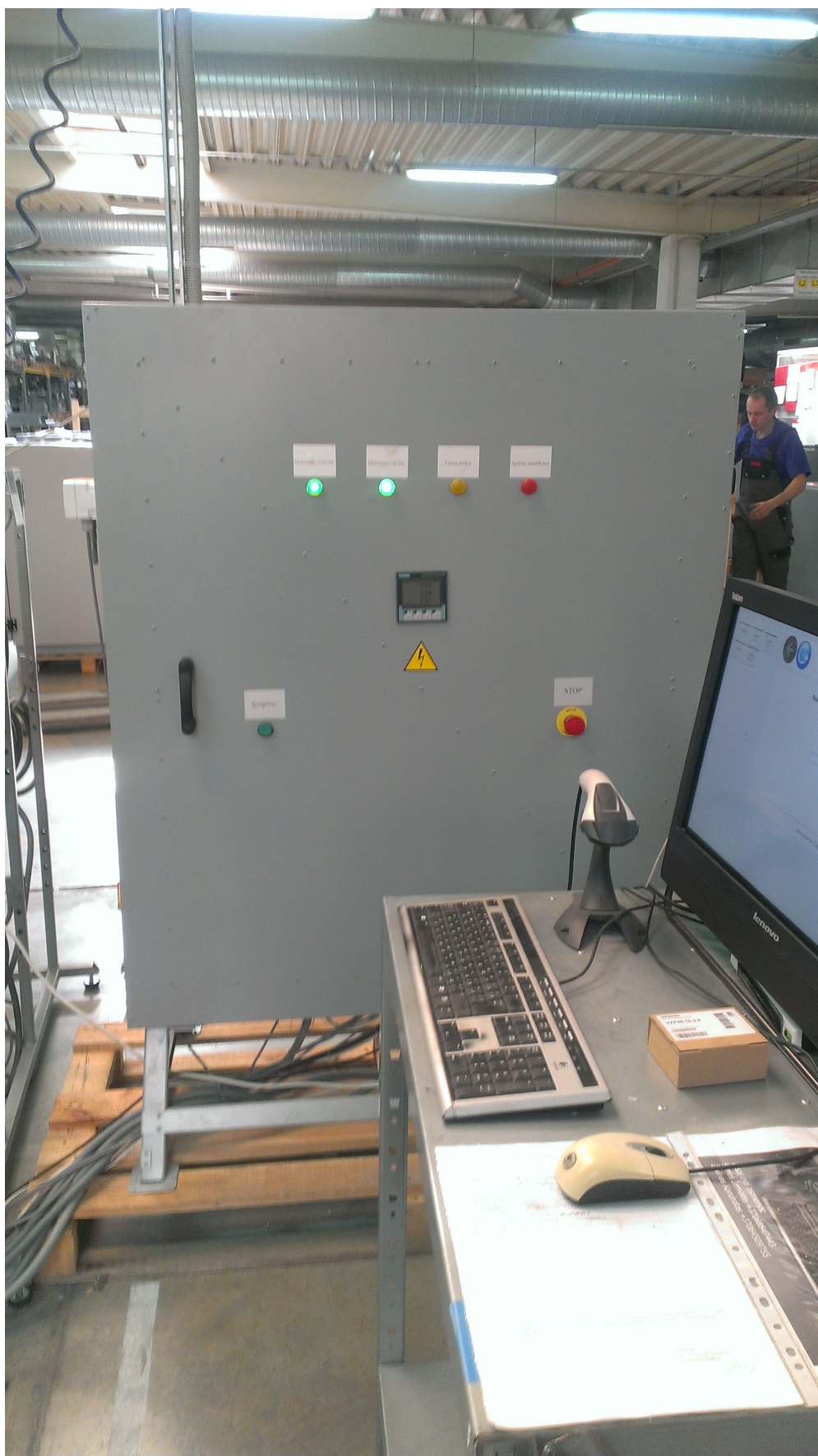
2.8.4. pav. patikros stendo skydas
