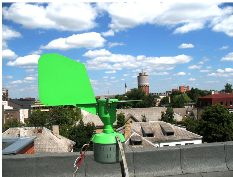
3 pav. Šiaulių mieste stovinti Hirst tipo tūrinė sporų gaudyklė (Gamtos mokslų fakultetas, Aplinkotyros katedra, 2008)
