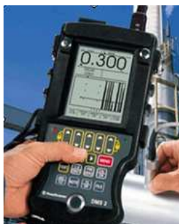
2.1 pav. Metalų ultragarsinis storių matavimo prietaisas
