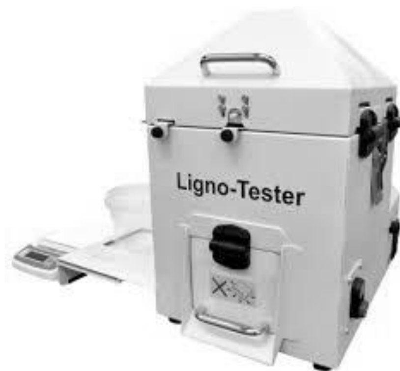
2.5 pav. Ligno-tester, specialiai skirtas medienos granuliu gamintojams
