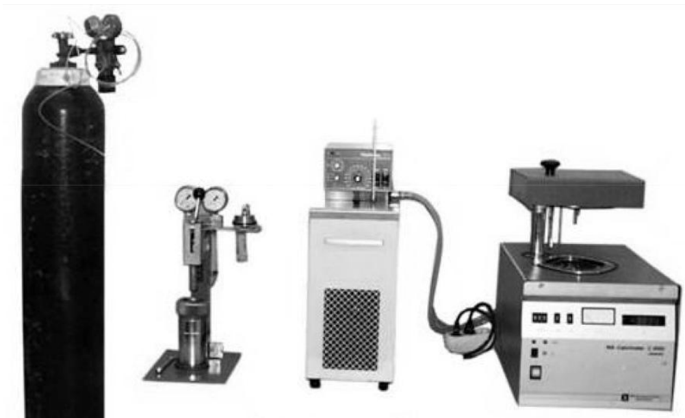
2.6 pav. IKA C4000 neautomatizuotos kalorimetro sudėtinės dalys
