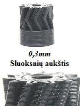
3.10 pav. Atspausdintos detalės sluoksnių aukštis – 0,3mm
