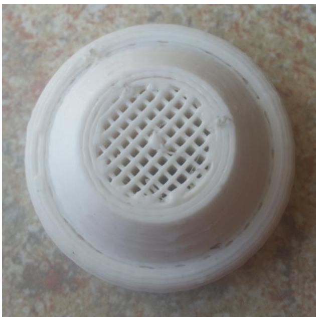
3.8 pav. Atspausdintos detalės užpildymas – 50%
