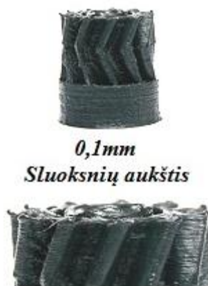
3.2 pav. Atspausdintos detalės sluoksnių aukštis – 0,1mm
