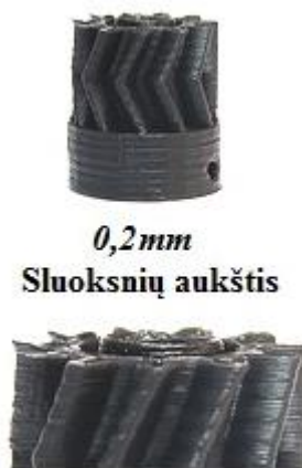
3.6 pav. Atspausdintos detalės sluoksnių aukštis – 0,2mm
