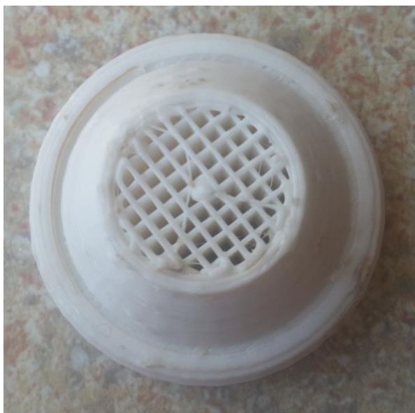
3.12 pav. Atspausdintos detalės užpildymas – 30%
