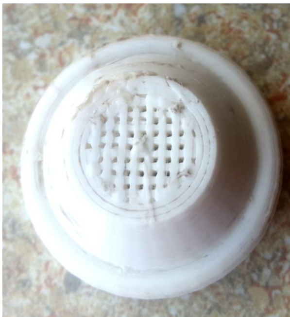
3.4 pav. Atspausdintos detalės užpildymas – 100%
