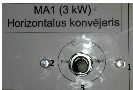
39pav. Būsenos indikacija ir srovės reguliavimas.
