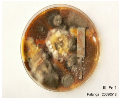
14 pav. Plieno plokštelės vaizdas po 30 d. sąlyčio su agarizuota salyklo ekstrakto terpe, užkrėsta nuo Baltijos jūros rytiniame pakraštyje pastatyto tilto plieninių sijų paimtų rūdžių ėminio dalelėmis: 1. Plieno plokštelės ir augančių grybų bendras vaizdas, 2. Plokštelės paviršiaus mikroskopinis vaizdas, x500, 3. Plokštelės paviršiaus mikroskopinis vaizdas, x1500
