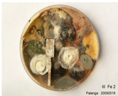
15 pav. Plieno plokštelės vaizdas po 30 d. sąlyčio su agarizuota salyklo ekstrakto terpe, užkrėsta nuo Baltijos jūros rytiniame pakraštyje pastatyto tilto plieninių sijų paimtų rūdžių ėminio dalelėmis: 1. Plieno plokštelės ir augančių grybų bendras vaizdas, 2. Plokštelės paviršiaus mikroskopinis vaizdas, x500, 3. Plokštelės paviršiaus mikroskopinis vaizdas, x1500
