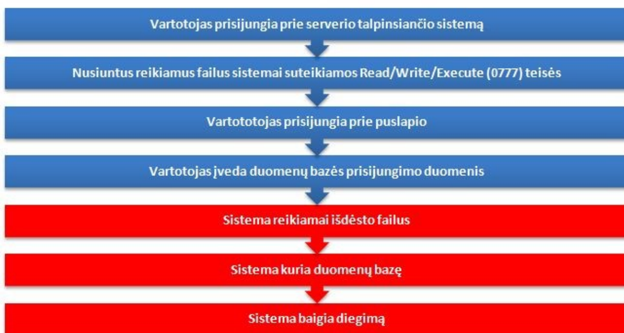
Pav. 3 Sistemos diegimo schema (sudaryta autoriaus)
