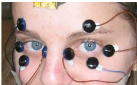
3.3 pav. EagleEyes akies sekimo sistemos elektrodai [3.3p]
