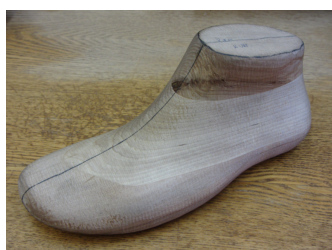
(a) Kurpalio paviršiaus segmentavimas
