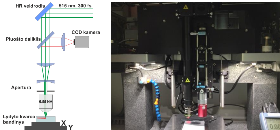
1 pav. Mikroapdirbimo sistemos optinė schema ir mikroapdirbimo sistemos darbinės zonos nuotrauka.
