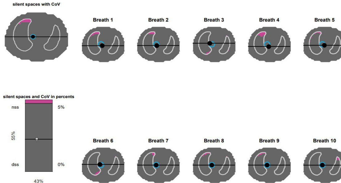
4 pav. EIT prietaiso pateikiamų vaizdinių „nebylių“ sričių ir ventilacijos centro rezultatų pavyzdys (kairėje – suvidurkinti vieno naujagimio rezultatai, dešinėje – „nebylių“ sričių ir ventilacijos centro dinamika). nss – nepriklausomos nuo gravitacijos plaučių sritys, dss – priklausomos nuo gravitacijos plaučių sritys. Suvidurkinant sumažinamas atsitiktinio triukšmo poveikis rezultatams ir paliekami tik pastovūs signalai, sujungiami keli matavimo ciklai arba signalai į vieną.
