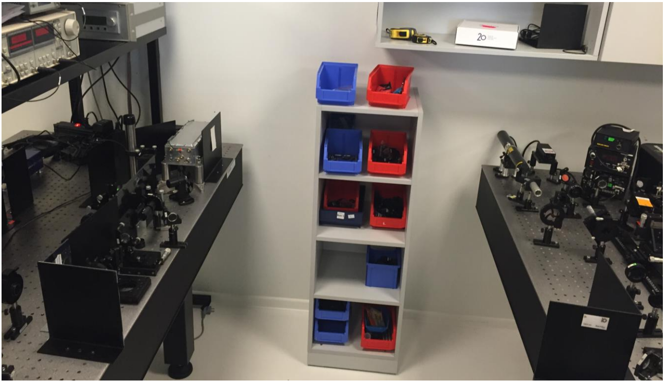
4.4 pav. Surinktas sugerties matavimo stendas
