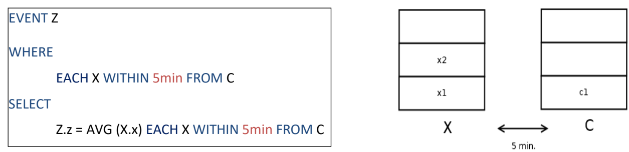
21 pav. Tęstinės užklausos T2 apibrėžimas ir užpildyti primityvių įvykių stulpeliai
