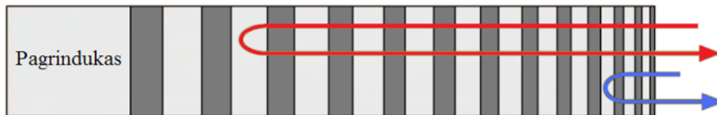
3 pav. Principinė vieno „čirpo“ struktūros shema, kur užvėlinama raudonoji komponentė
