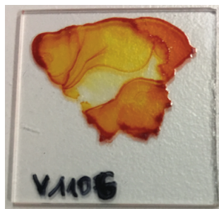
15 pav. Sugerties spektro matavimui paruoštas bandinys
