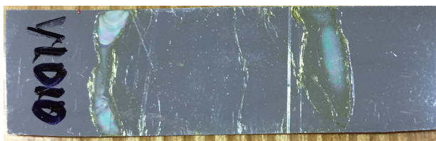
14 pav. Jonizacijos potencialo matavimui paruoštas bandinys
