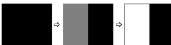
2.1.5 pav. Šviesos modulatoriaus ekranas, kai fazė vienoje pusėje yra nuosekliai keičiama (fazės vėlinimo koeficiento vertė kinta nuo 0 iki 255), o kitoje pusėje – nekinta
