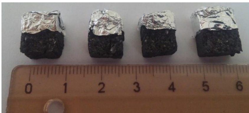
18 pav. Tyrime naudoti RBMK reaktoriaus kolonos grafito bandiniai.
