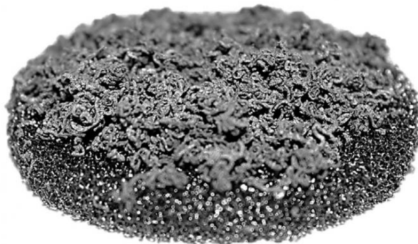
1.5.1 pav. Išsluoksniuoto grafito struktūra [30].
