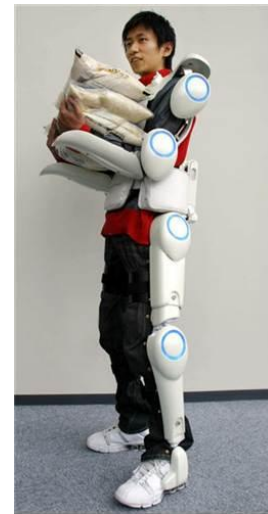
11 pav. HAL egzoskeletas: (b) HAL 5 pilnas egzoskeleto kostiumas
