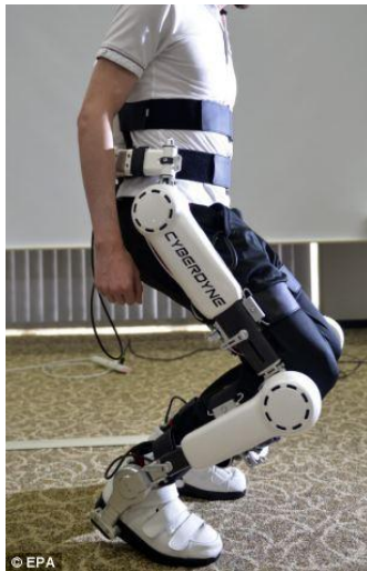
11 pav. HAL egzoskeletas: (a) HAL 3 skirtas tik apatinėms galūnėms
