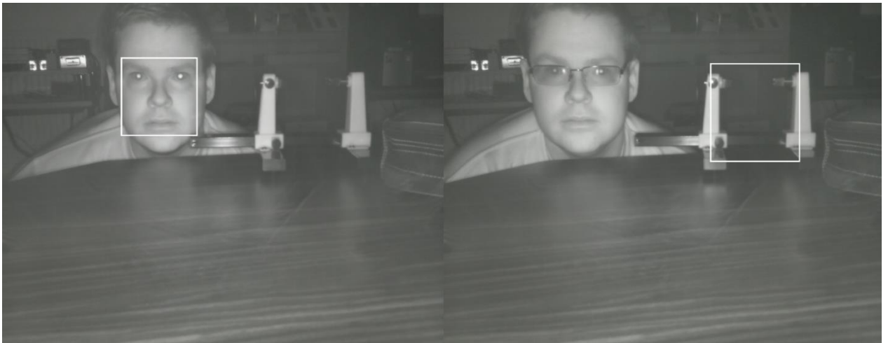
44 pav. Veido atpažinimo neuroninio tinklo rezultatai: rezultatas su išjungtu apšvietimu ir įjungta naktinio matymo sistema (iš kairės veidas be akinių, iš dešinės - su akiniais). Naudota maksimali Raspberry kameros raiška: 5 MP
