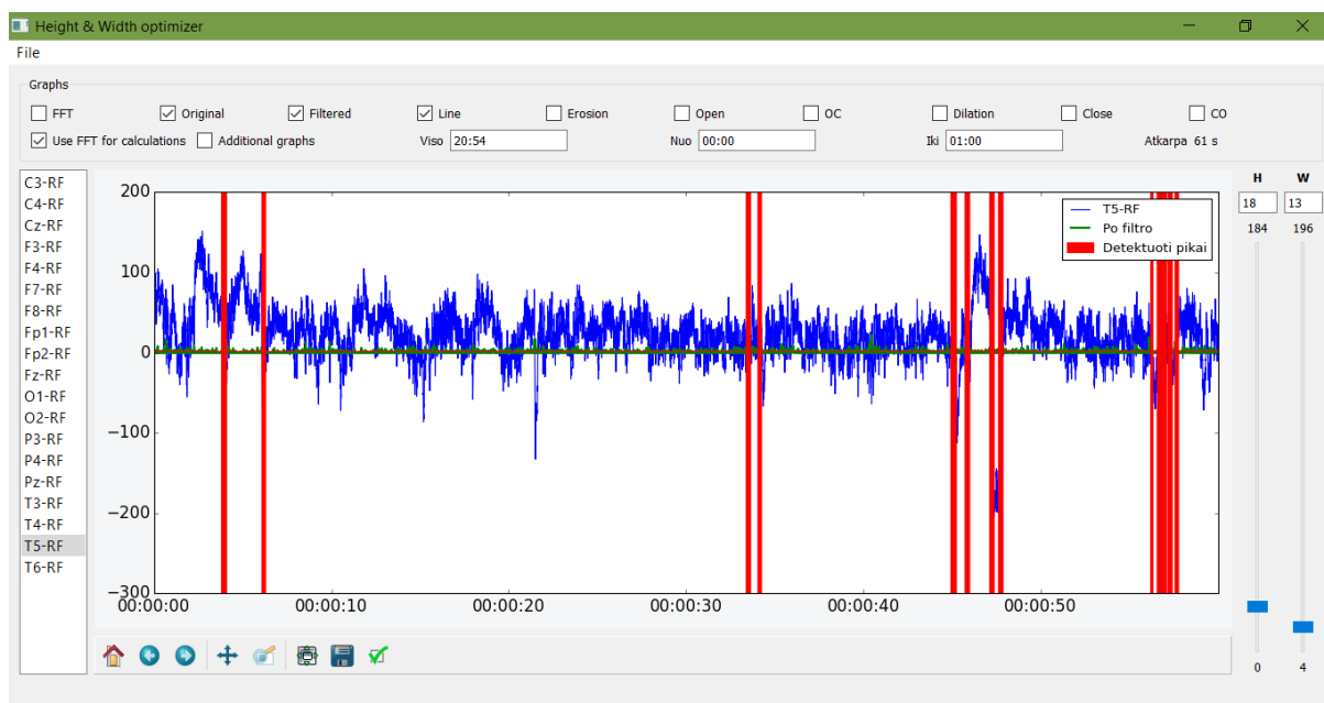
8 pav. Sukurtoje grafinės sąsajos formoje, yra galimybė pasirinkti norimą signalą, jo tiriamą kanalą, bei keičiant H (aukštis) ir W (plotis), stebėti kaip kinta pasirinkto signalo grafikas, bei detektuojamų pikų skaičius
