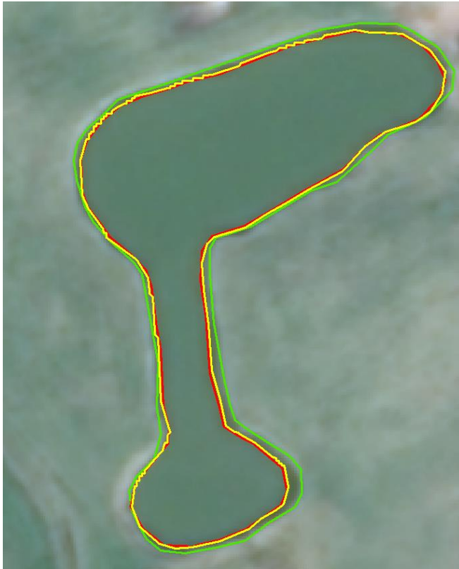
18 pav. HD – 3 vandens telkinio ribos nubrėžtos rankiniu (žalia linija) ir automatiniais būdais (raudona – kontrol., geltona – nekontr.)
