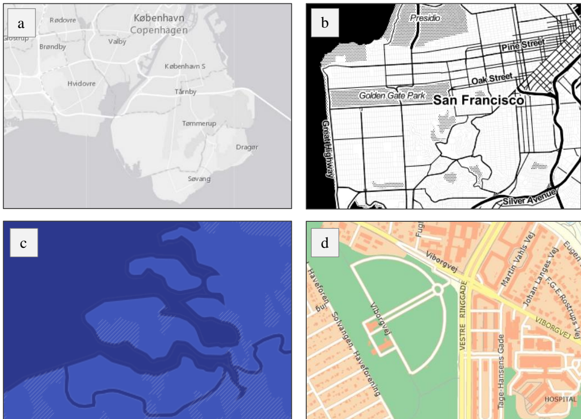
4 pav. Foninių geografinio pagrindo žemėlapių pavyzdžiai pagal spalvų panaudojimo klasifikaciją (a – vienspalvis achromatinis, pilkas, pvz. AGOL „drobės“ (angl. Canvas ) šviesiai pilkas (angl. light gray ); b – vienspalvis achromatinis, juodai baltas, pvz. CartoDB – Pozitronas (angl. Positron ); c – vienspalvis chromatinis, mėlynas, pvz. CartoDB – pasaulio šviesiai mėlynas (angl. World Light Blue ); d – įvairiaspalvis, pvz. Danijos nacionalinio erdvinių duomenų portalo Kort žemėlapis.
