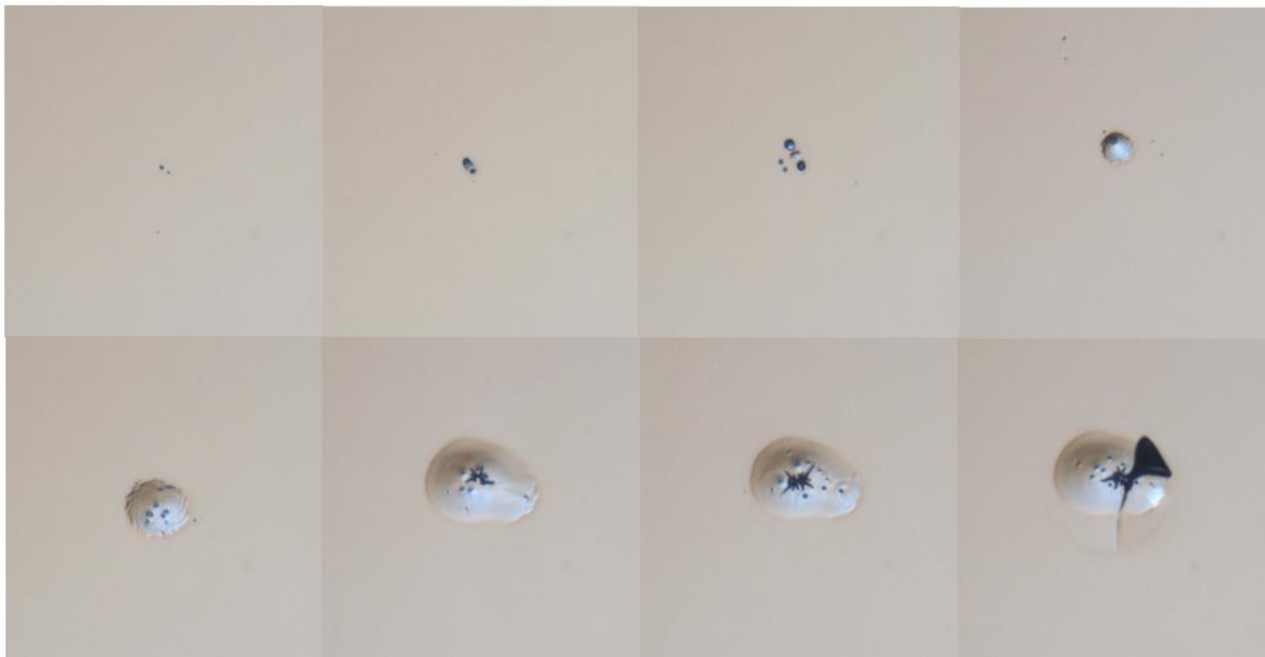
24 pav. Optinės pažeidimo morfologija bandinio paviršių ekspozuojant pavieniais nanosekundiniais UV spinduliuotės impulsais
