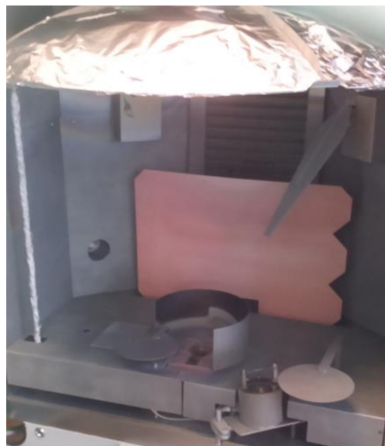
Pav. 18. PEN plėvelės ir MAKROFOL dengimas LiB sluoksniu
