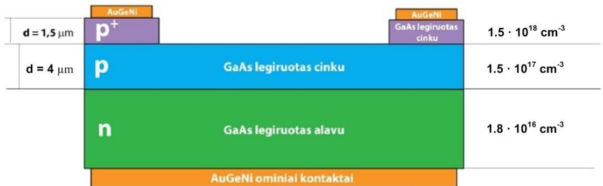
25 pav. GaAs pn sandūros struktūra ir sudėtis
