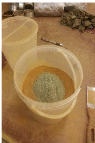
12 pav. Molio ir cemento kiekiai paruošti maišymui sausu būdu (K. Zokaitės nuotr.).
