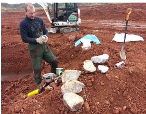
7 pav. Suardytos ir nesuardytos sandaros triaso molio bandinių ėmimas ir konservavimas (K. Zokaitės nuotr.).
