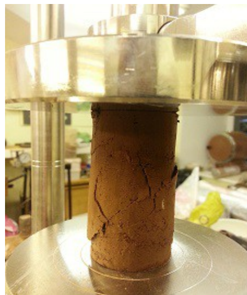
18 pav. Vienašio nedrenuoto nekonsoliduoto gniuždymo bandymas (K. Zokaitės nuotr.).
