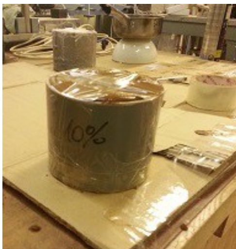
15 pav. Molio-cemento bandinio supyli – mas į konservavimo tarą (K. Zokaitės nuotr.).
