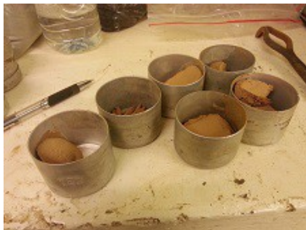
20 pav. Plastingumo drėgnio nustatymo bandymas kočiojimo metodu (K. Zokaitės nuotr.).
