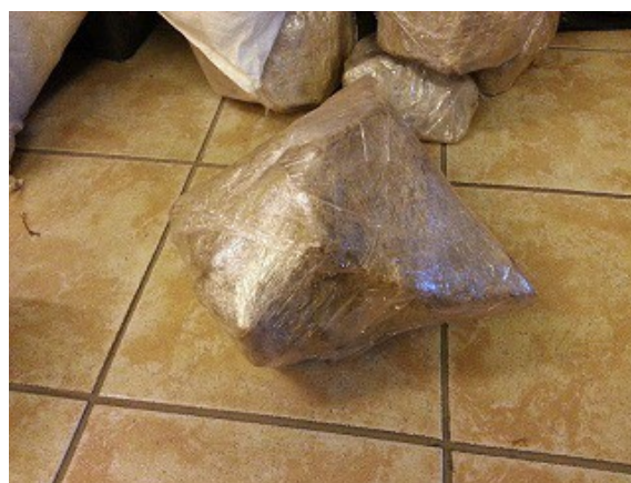
8 pav. Bandinių laikymas VU gruntotyros laboratorijoje (K. Zokaitės nuotr.).
