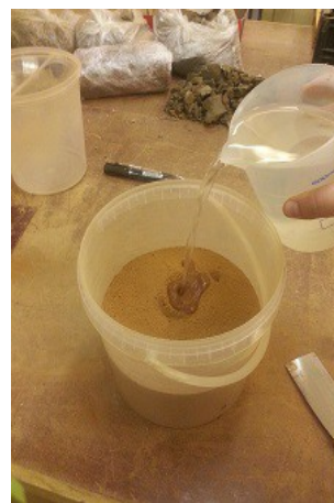
13 pav. Į paruoštą, sausu būdu sumaišytą molį ir cementą pilamas vanduo (K. Zokaitės nuotr.).
