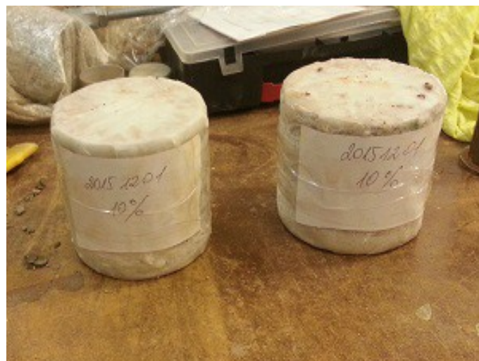
16 pav. Paruoštų molio-cemento bandinių konservavimas (K. Zokaitės nuotr.).
