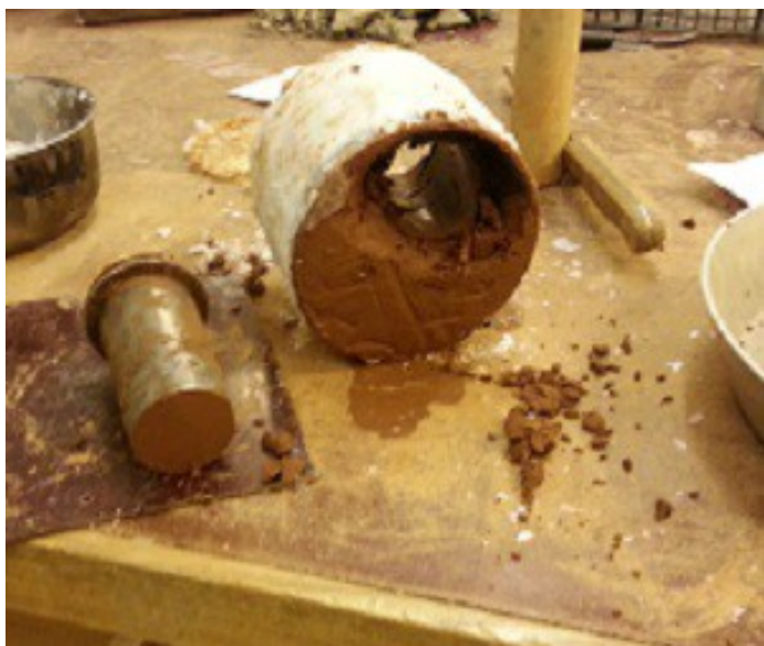
17 pav. Molio-cemento mišinio bandinio suformavimas vienašiam nedrenuotam nekonsoliduotam gniuždymui (K. Zokaitės nuotr.).
