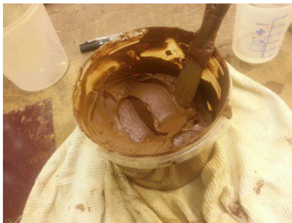
14 pav. Molio-cemento bandinio paruošimas maišant rankiniu būdu (K. Zokaitės nuotr.).
