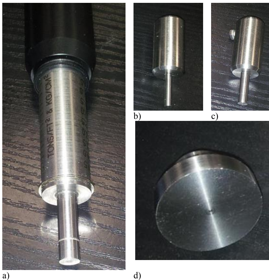
2.2.2 pav. Kišeninis penetrometras a) standartinis antgalis (PP), b) labai mažas (VSPP), c) mažas (SPP) ir didelis (LPP)
