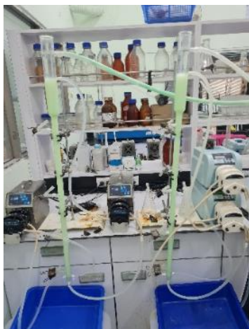
2 pav. Homogeninės kristalizacijos verdančio sluoksnių reaktoriai
