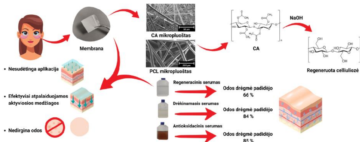
1 pav. Funkcinių polimerinių membranų gavimo schema
