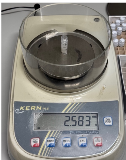
2 pav. Surinktų seilių svėrimas naudojant Kern PLS Analytical Balance svarstyklės.
