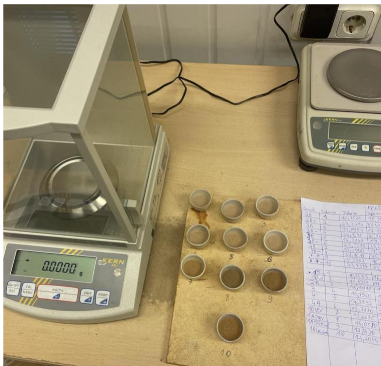
6 pav. Mėginių paruošimas organinės medžiagos kiekio nustatymui.
