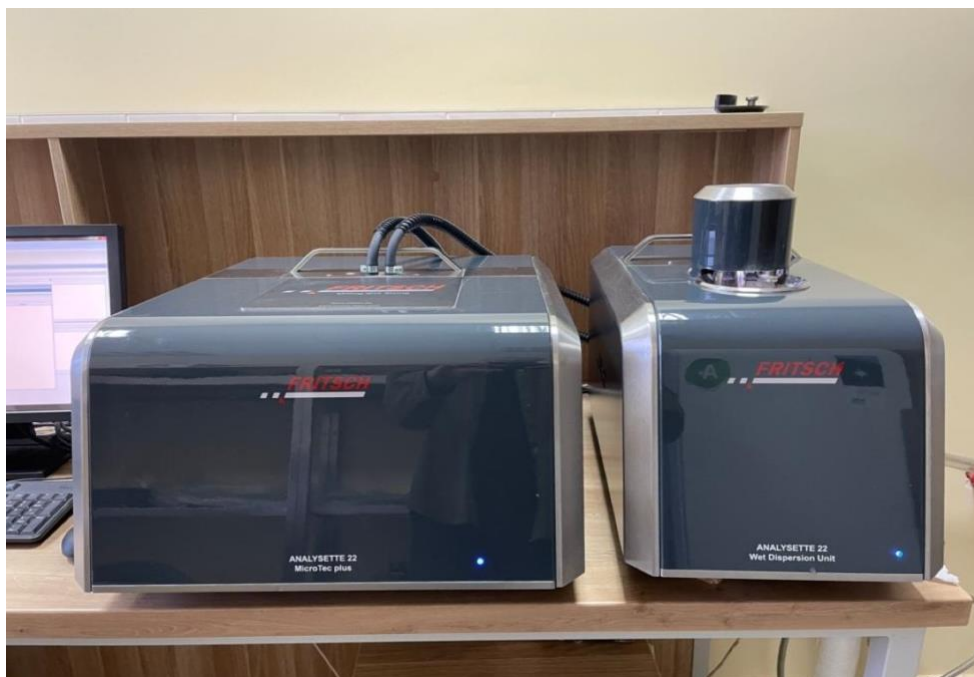
5 pav. Lazerinis dalelių dydžio nustatymo difrakcinis aparatas Fritsch Analysette 22 MicroTec plus.
