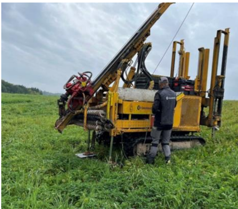
12 pav. Telšių rajone atliekamas statinio zondavimo bandymas. Autoriaus nuotrauka
