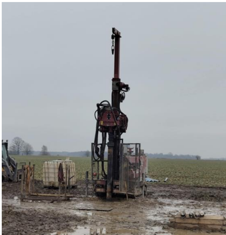
13 pav. Nesuardytos sandaros bandinių ėmimas ir gręžinio sekliškai seismikai paruošimas naudojant Royal Eijkelpkamp CompactRotoSonic 140 agregatą. Autoriaus nuotrauka
