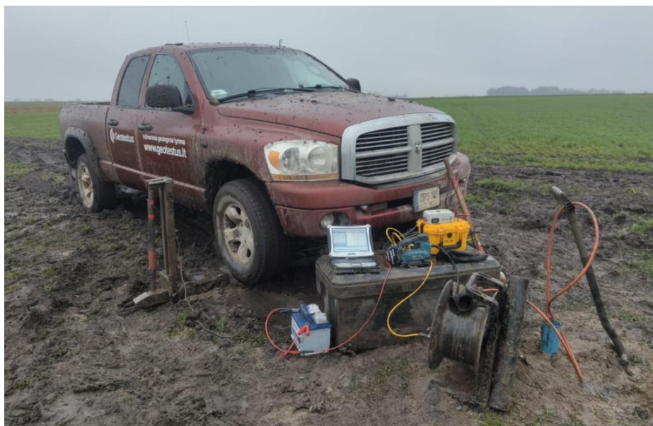
14 pav. Pasiruošimas sekliosios seismikos bandymui Naujosios Akmenės tyrimų aikštelėje. Autoriaus nuotrauka
