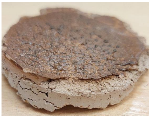
6 pav. Atsiskyrusi molio frakcija bandinio paviršiuje. Nuotrauka autorės.
