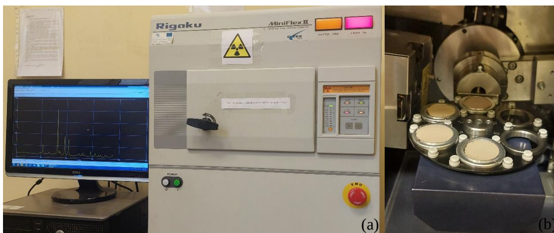
8 pav. Mineraloginės sudėties tyrimas: (a) rentgeno spindulių difraktometras; (b) bandiniai. Nuotraukos autorės.
