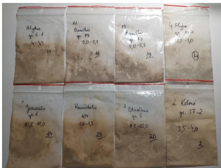
7 pav. Keletas sutrintų bandinių, paruoštų cheminės ir mineraloginės sudėties analizėms. Nuotrauka autorės.
