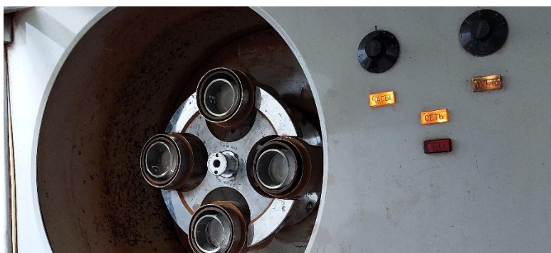
5 pav. Bandiniai centrifugoje. Nuotrauka autorės.
