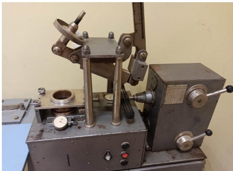
22 pav. Tiesioginio kirpimo aparatas (Sušinskis, 2023).
