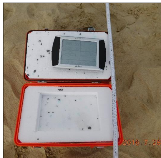
24 pav. Meteorologinė stotelė su duomenų kaupikliu (A. Kalesnikas, 2016)
