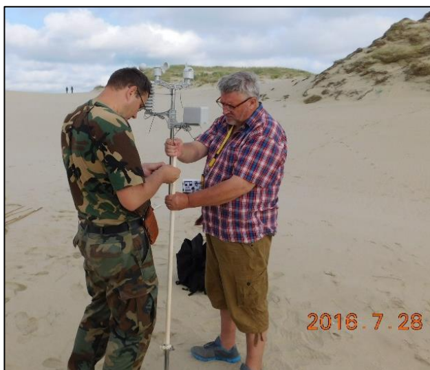
24 pav. Meteorologinė stotelė su duomenų kaupikliu (A. Kalesnikas, 2016)
