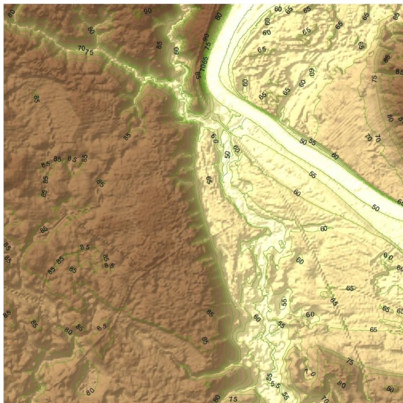
44 pav. Izohipsių vaizdas prieš (raudona) ir po (žalia) generalizavimo procedūrų, kai laiptas 5 metrai
