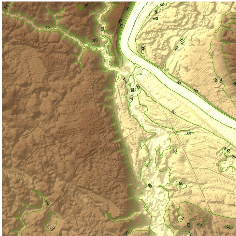
45 pav. Izohipsių vaizdas prieš (raudona) ir po (žalia) generalizavimo procedūrą, kai laiptas 10 metrų
