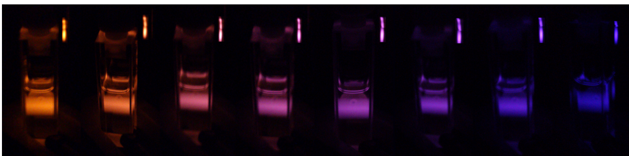
(c) Fluorescencijos spalvos pasikeitimas palaipsniui didinant \text{Hg}^{2+} koncentraciją NI1 tirpale. NI1 darinio ir gyvsidabrio jonų koncentracijų santykiai iš kairės į dešinę: 9:1; 4:1; 1,5; 1:1; 1:1,5; 1:2,3; 1:4; 1:9.
